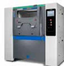
Manipulační stanice X LINE PCG s kolébkou pro manipulaci s paletou (opce)
