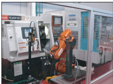
Výrobní buňka s robotem Nachi
