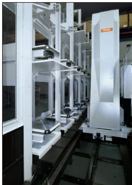
Detail manipulátoru a zásobníku palet
