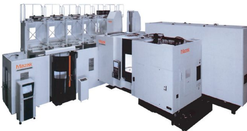
Mazak Paletech s tříúrovňovým zásobníkem palet (základní sestava)
