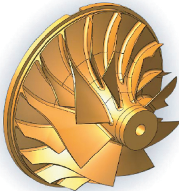
Jedna z ukázek obrábění: turbínové kolo o průměru 160 mm, materiál 14 220
