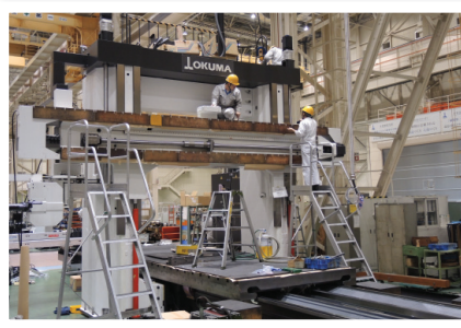
Montáž portálových center se nevidí tak často. Okuma je specialista na tyto stroje, v loňském roce pokryla 45 % světového trhu. Zde montáž probíhá celkem ve třech lodích haly, na jedné straně menší portály, prostřední a pravá část je pak určena pro portálová centra střední a velké velikosti. Doba montáže je od 20 do 25 dnů v závislosti na velikosti a složitosti stroje.
