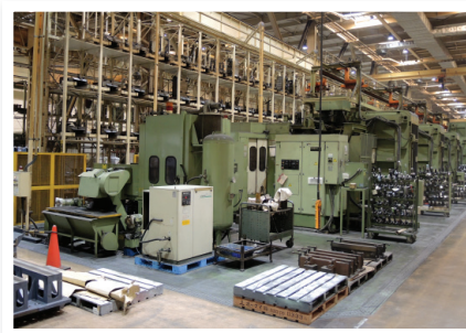
Pružný výrobní systém v hale K2 přestavuje 18 400 m 2 výrobního prostoru o pětadesát strojích ve čtyřech řadách obsluhovaných devíti regálovými zakladači. Obrobené díly odvázejí automatické magnetické dopravníky na kontrolní měření.
