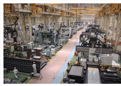
Montáž portálových center se nevidí tak často. Okuma je specialista na tyto stroje, v loňském roce pokryla 45 % světového trhu. Zde montáž probíhá celkem ve třech lodích haly, na jedné straně menší portály, prostřední a pravá část je pak určena pro portálová centra střední a velké velikosti. Doba montáže je od 20 do 25 dnů v závislosti na velikosti a složitosti stroje.
