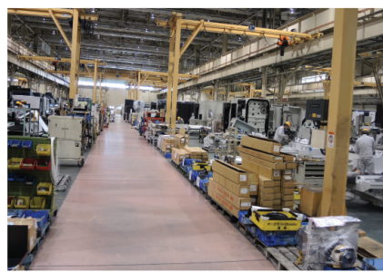
Obráběcí centra a jejich montáž ve třech krocích, na třech místech. V prvním dochází k sestavení hlavních dílů stroje a následné měření (i u menších strojů jsou vidět velmi robustní odlitky stojanů), v druhém kroku se stroj převezne na mechanickou montáž a opět se měří, v závěrečném kroku je pak stroj finálně zakrytován a podroben závěrečnému testování. Celá montáž i v těch nejsložitějších případech konstrukce stroje nepřesáhne sedm pracovních dnů.
