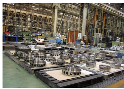
Pružný výrobní systém v hale K2 přestavuje 18 400 m 2 výrobního prostoru o pětadesát strojích ve čtyřech řadách obsluhovaných devíti regálovými zakladači. Obrobené díly odvázejí automatické magnetické dopravníky na kontrolní měření.
